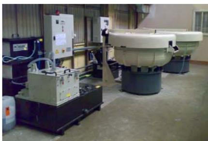
4. В целях обеспечения дальнейшей автоматизации производства лопаток компрессора освоен техпроцесс объемного виброшлифования на установках R620 и R420 фирмы «Rösler» (Германия) и внедрена обработка 5 наименований деталей НК-16СТ, НК-38СТ.
