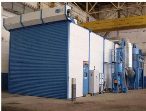
позволяют обрабатывать поверхность всех имеющихся в составе ГПА крупногабаритных узлов двумя операторами одновременно. Применение стальной колотой дроби в камере позволило не только ускорить процесс качественной обработки поверхности, но и значительно улучшить условия труда операторов. Стоимость камеры - 6 600 тыс.рублей. Экономический эффект от внедрения данного оборудования составляет 2 млн. рублей в год.
