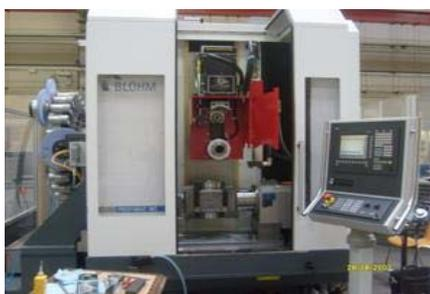
3. В рамках реализации программы развития лопаточного производства освоен станок для обработки лопаток турбины «Profimat MC607» компании «Blohm» (Германия) и внедрена обработка секции сопловой 2 ступени изделия НК-38СТ и секции сопловой 2 ступени изделия НК-16СТ в цехе №3.
