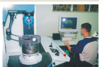
Межоперационный и окончательный контроль колес зубчатых передач по всем параметрам зубчатого соединения с применением контрольно-измерительных машин. Автоматическая обработка результатов замеров с распечаткой протокола.
