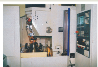
Зубодолбление внутреннего зубчатого зацепления цилиндрических косозубых колес на высокопроизводительных станках с ЧПУ косозубыми долбяками: – обеспечение точности до 6 степени; – производительность 600 дет.оп./месяц при номенклатуре 4 дет.
