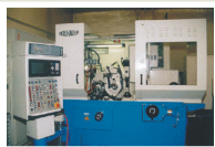
Зубошлифование цилиндрических прямозубых и косозубых колес методом непрерывного шифтингового шлифования на высокопроизводительных станках с ЧПУ многозаходными высококористыми кругами: – обеспечение точности до 4 степени; – производительность 6000 дет.оп./месяц при номенклатуре 50 дет.
