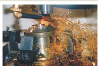
Зубодолбление внутреннего зубчатого зацепления цилиндрических косозубых колес на высокопроизводительных станках с ЧПУ косозубыми долбяками: – обеспечение точности до 6 степени; – производительность 600 дет.оп./месяц при номенклатуре 4 дет.
